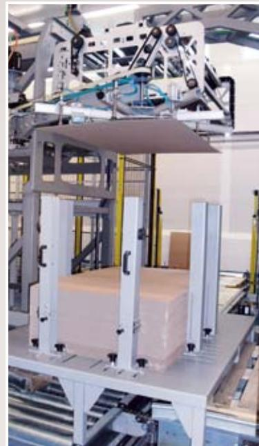
transportadoras Smiline hasta la entrada del sistema automático de paletización Smipal APS 3080 PR, que los agrupa en europalés de 800x1200 mm y de 1000x1200 mm. El paletizador instalado por Pinar Su es un sistema mono-columna de dos ejes cartesianos con movimientos desde abajo; el eje vertical está formado por una columna fija a lo largo de la cual se desliza, sobre
