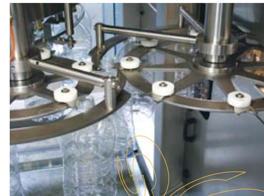
El sistema integrado Smiform instalado en el establecimiento de Pinar Su produce envases PET de 3.25 L y 5 L a una velocidad de 6.000 botellas por hora y envases de 10 L a 4.200 botellas por hora. El rendimiento horario de la nueva instalación satisface a la perfección las necesidades de embotellado de la empresa, ya que con una sola máquina se obtiene una capacidad de producción igual a la que
