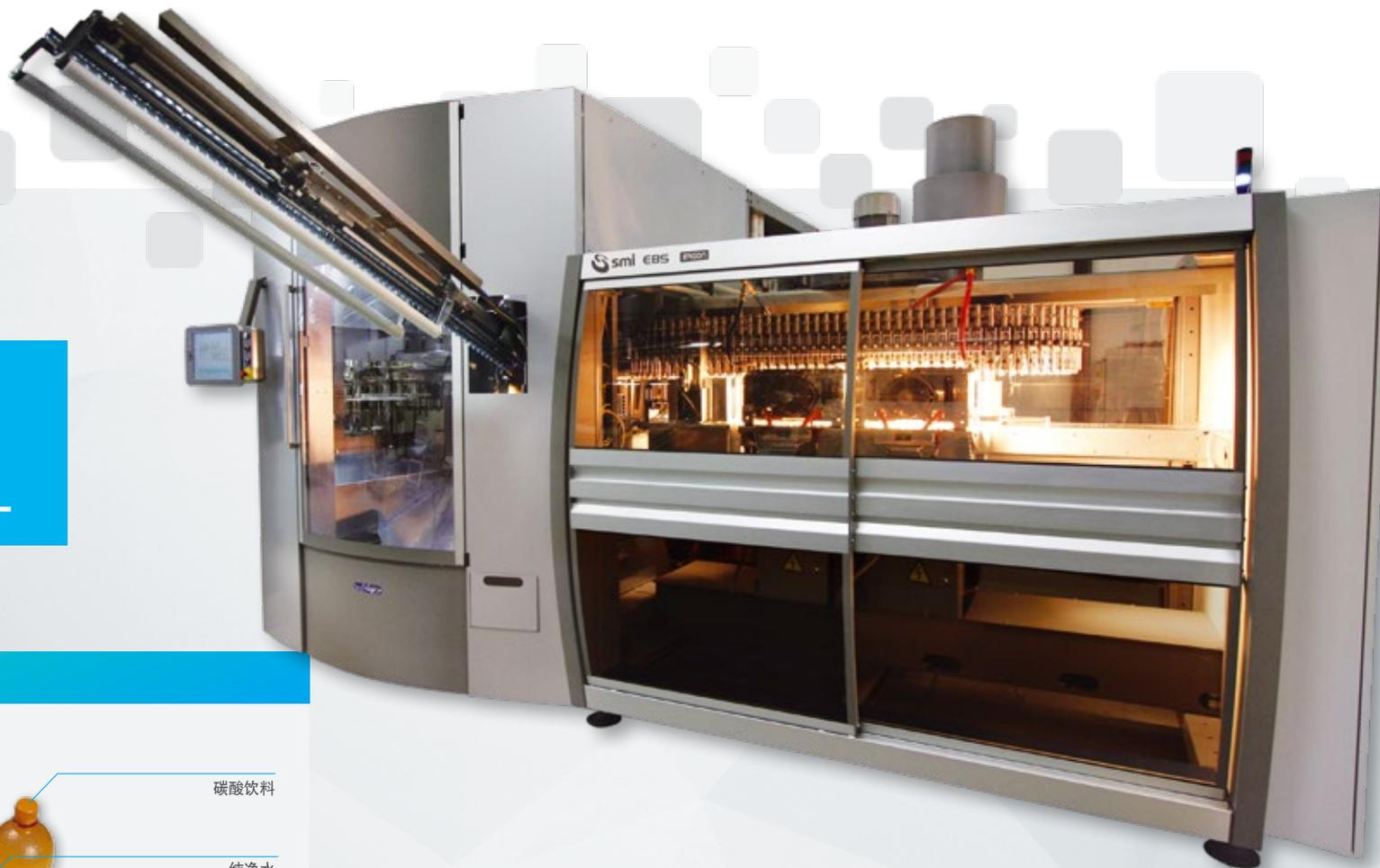
全新的EBS ERGON系列（电子式吹瓶系统）“无凸轮”的设计，其伸拉-吹瓶过程完全电子式控制，如此的高科技成就是SMI 20年来日积月累发展旋转式吹瓶机的经验以及二来年积极努力研究的成果。
