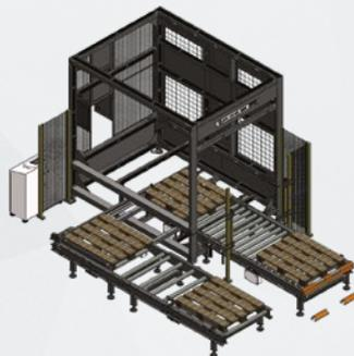
Le protezioni in rete sono montate a bordo macchina, tranne nella zona di carico/scarico bancale dove invece sono fissate a terra. Sono presenti uno scarico per il passaggio del bancale in zona carico paletta vuota e barriere ottiche con dispositivo di muting per la zona di uscita bancale pieno.
