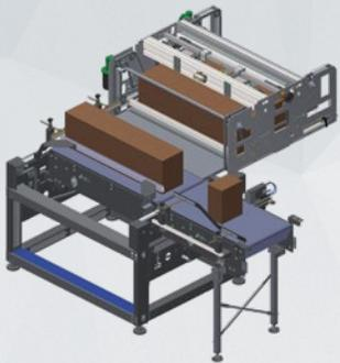
Il trasferimento della fila è gestito da una barra motorizzata. La fila formata è spinta direttamente nella testa di presa (cestello). Il sistema è dotato di una piastra "morta" (cuscinetto), che consente di continuare l'introduzione delle file anche quando la testa non è ancora in posizione di presa.
