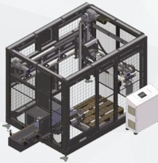
Le protezioni in rete sono montate direttamente a bordo macchina; il carico/scarico del bancale avviene attraverso una porta a doppio battente provvista di serratura di sicurezza con elettromagnete.
