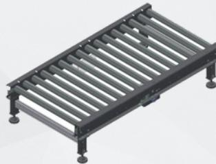
Struttura in acciaio verniciato e rulli  $\varnothing$  76 mm passo 150 mm, motorizzati mediante catena da 5/8 di pollice. Motorizzazione centrale reversibile elettronicamente. Il sistema viene testato in SMI e fornito al cliente completamente montato e cablato. Disponibile in diverse lunghezze da 1500 mm, 2000 mm, 2500 mm e 3000 mm.
