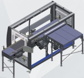
Ingresso singolo con formazione strato a 90° completo di: 1 tappetino cadenzatore gommato, 1 tappeto d'introduzione prodotto con la funzione di formare la fila e 1 sistema di traslazione con movimento unidirezionale, che contribuisce alla formazione dello strato. Il sistema, progettato secondo
