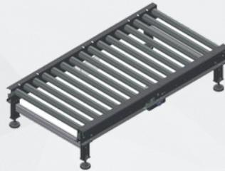
Struttura in acciaio verniciato e rulli  $\varnothing$  76 mm passo 150 mm, motorizzati mediante catena da 5/8 di pollice. Motorizzazione centrale reversibile elettronicamente. Il sistema viene testato in SMI e fornito al cliente completamente montato e cablato. Disponibile in diverse lunghezze da 1500 mm, 2000 mm, 2500 mm e 3000 mm.
