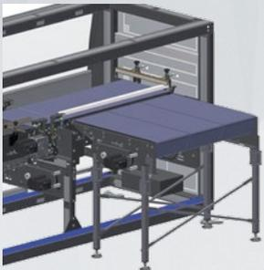
Il trasferimento della fila è gestito da una barra motorizzata. La fila formata è spinta su un tappeto di preformazione strato. Il trasferimento dello strato dal tappeto alla testa di presa (cestello) avviene in maniera fluida e precisa, poiché il sistema sfrutta il movimento del tappeto e non richiede l'impiego di elementi di traslazione meccanica dello strato.
